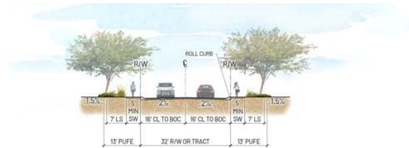
**J** 32' TYPICAL LOCAL STREET SECTION (ATTACHED SIDEWALK)
